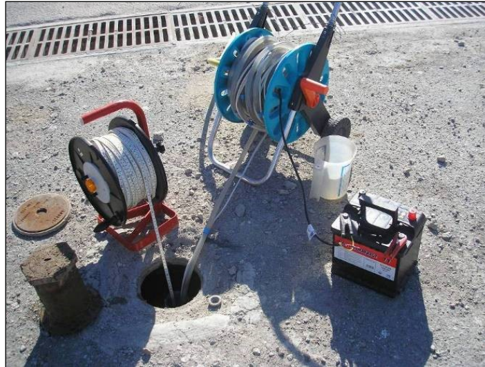
Photo 1 : Matériel de prélèvement des eaux souterraines
